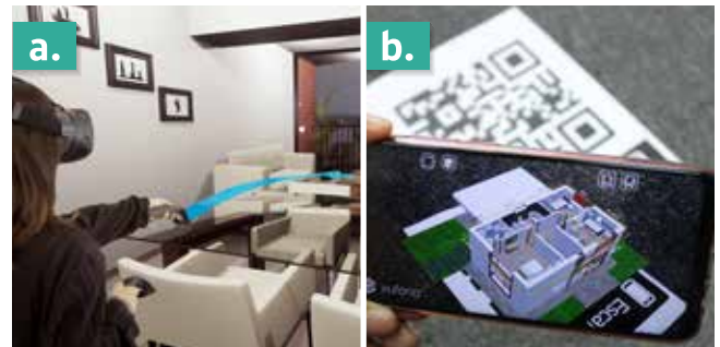
Figura 3. Diferencias en la visualización con RA y RV: (a) visualización inmersiva e interactiva de un departamento piloto con RV, (b) visualización de un modelo 3D proyectado en el entorno real con RA.
