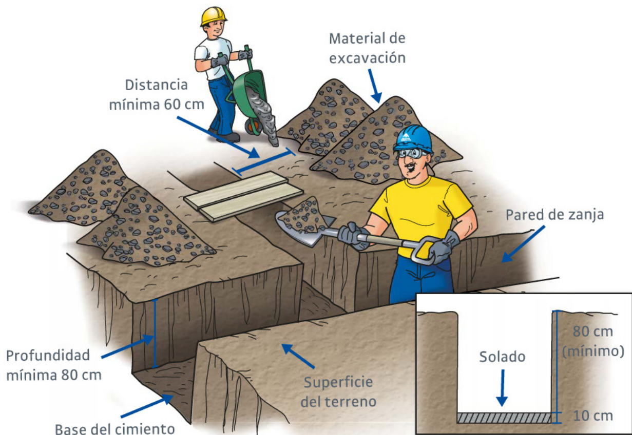
Sección transversal de la zanja.
