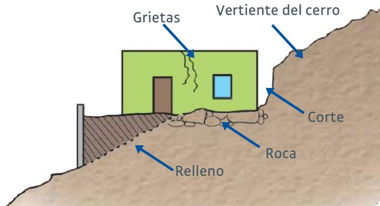
Figura 10. Efectos en una construcción sobre roca y relleno.
