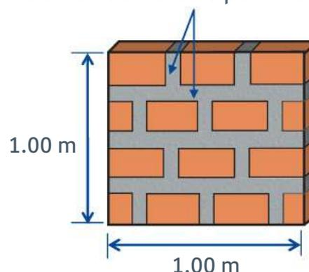
Por ejemplo, si se quiere calcular la cantidad de mortero que se empleará en el asentado de sogas de ladrillo King Kong (9x13x24) por m<sup>2</sup> de muro con 1.5 cm. de junta horizontal y vertical, se tendrá lo siguiente:
