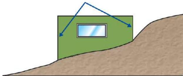
Figura 8. No construir muros con alturas diferentes.
