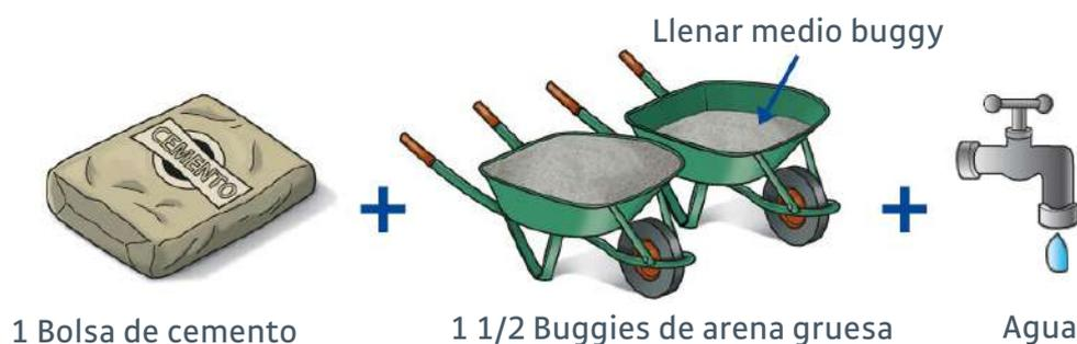
La preparación del concreto se podrá realizar con la ayuda de una mezcladora o a mano en una superficie lisa y limpia. En cualquiera de los dos casos, la proporción recomendable es de una bolsa de cemento por 1 1/2 buggies de arena gruesa, tal como se ve en la sección 1.12 de este manual. Adicionalmente, se agregará la cantidad de agua necesaria para obtener una mezcla pastosa que permita un buen trabajo.
