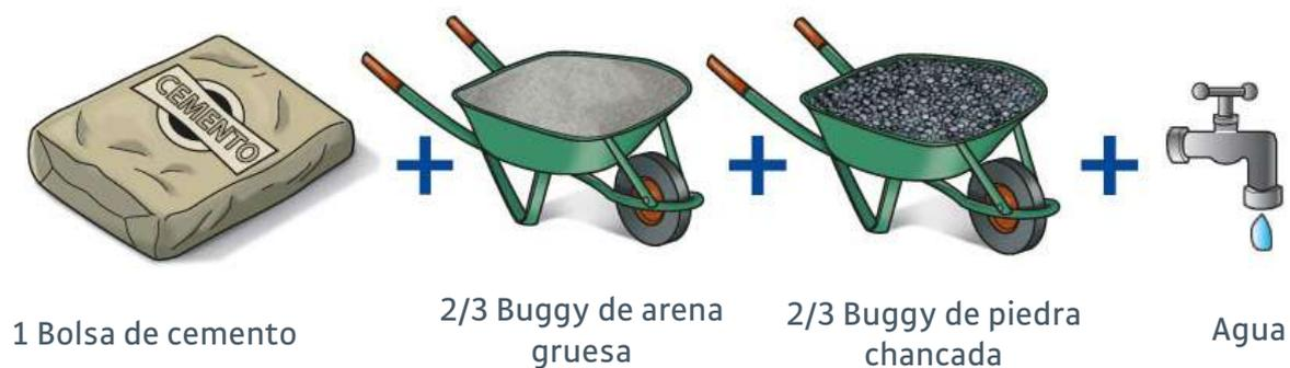
Durante el proceso de mezclado, primero deberá ingresar una parte del agua en la mezcladora, antes que el cemento y los agregados. Luego, se echa el resto. Asimismo, el tiempo de mezclado, una vez que todos los materiales han ingresado, no será inferior a dos minutos.
