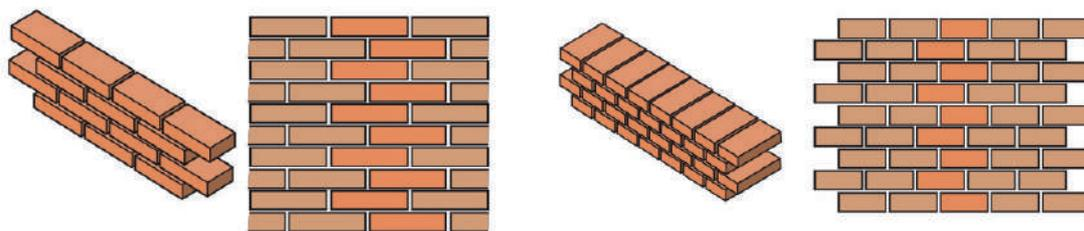
Figura 86. Muro de Soga - Espesor: 13 cm      Muro de Cabeza - Espesor: 24 cm
