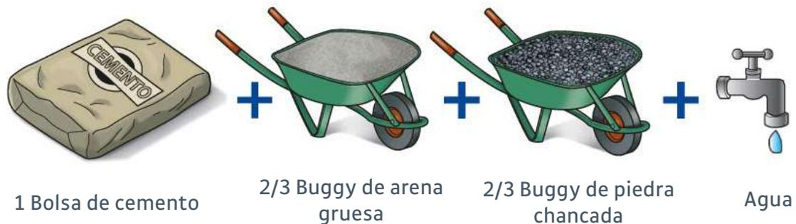
Este concreto, al igual que en las columnas y vigas, debe hacerse de preferencia usando una mezcladora, ya que hacerlo de manera manual produce mezclas que no son uniformes.
