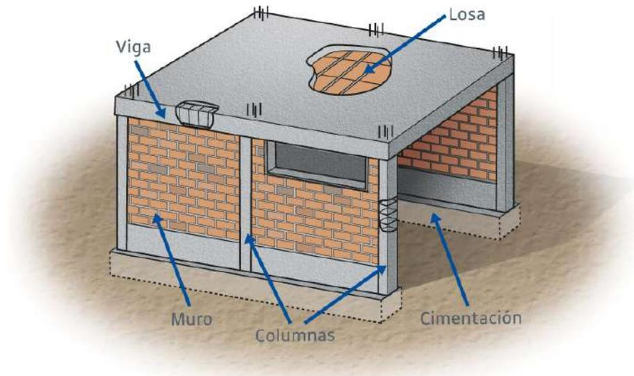
Figura 2. Elementos estructurales de la vivienda (albañilería confinada).
