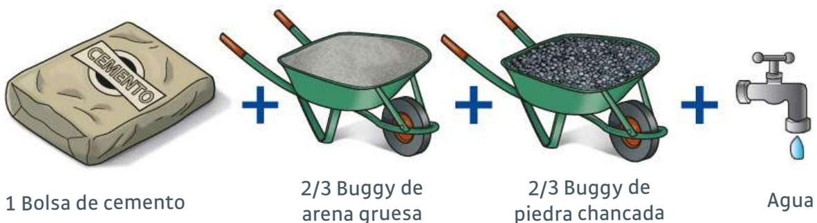
De preferencia, debe usarse mezcladora para obtener una mejor mezcla de los materiales. Debe batirse en seco con lampa, un mínimo de tres o cuatro veces, hasta que tenga un color parejo. Luego, agregar agua en la cantidad indicada arriba para que la mezcla quede pastosa y trabajable.
